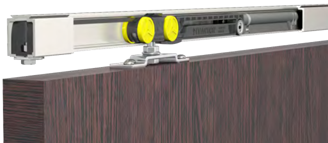
Przykład zamontowania domykacza M66S ukrytego w prowadnicy
